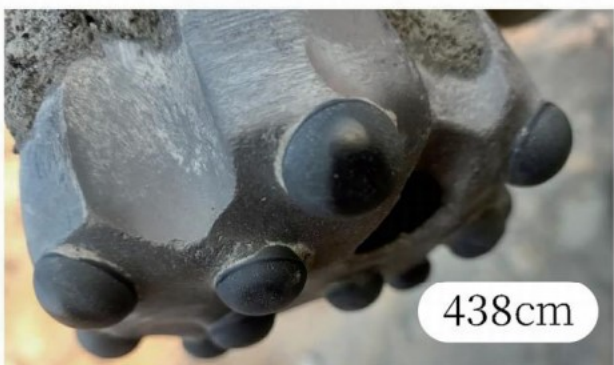
金刚石复合球齿钻头在碎石场进尺1200多米实像磨损状态
