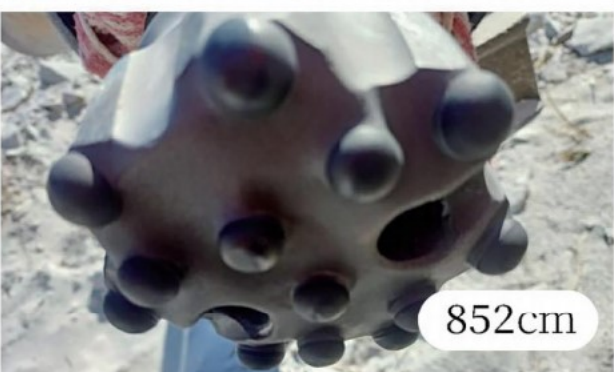
金刚石复合球齿钻头在碎石场进尺1200多米实像磨损状态
